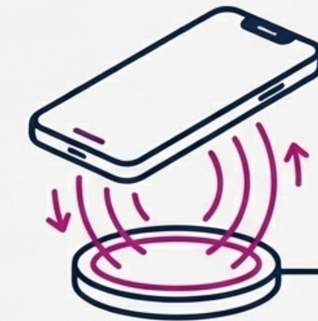
**Función:** Transfieren energía eléctrica a través del aire mediante campos magnéticos.
